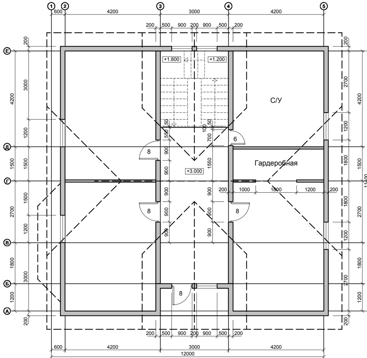
Все Размеры и Отметки даны по Металлическому Каркасу:
